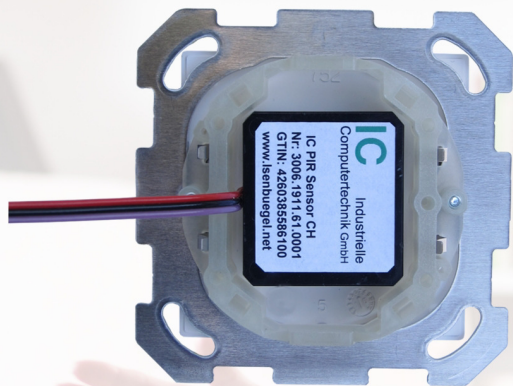
Rückseite des PIR Sensors in einer Blindabdeckung mit Montagerahmen und Befestigungsplatte
